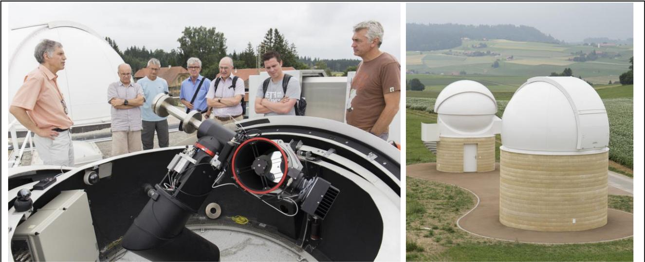
Prof. Thomas Schildknecht erläutert das robotische ASA-Kleinteleskop zur CCD Überwachung von Weltraumschrott. Das „Geheimnis“ liegt insbesondere auch in der selbst entwickelten Software. Zwei neue Kuppelobservatorien für den weiteren Ausbau des Instrumentenparks wurden soeben errichtet.
